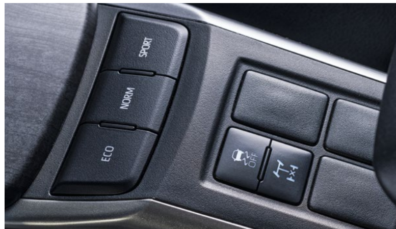
Принудительная блокировка заднего дифференциала
